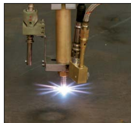
Wstępne podgrzewanie z FIT™
