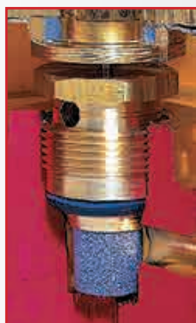
Jednoelementowe gniazdo w obudowie z wewnętrznym fi Iitem
