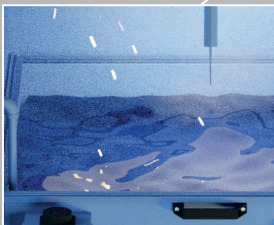
Iskry wpadają do kąpeli wodnej i wygasają
